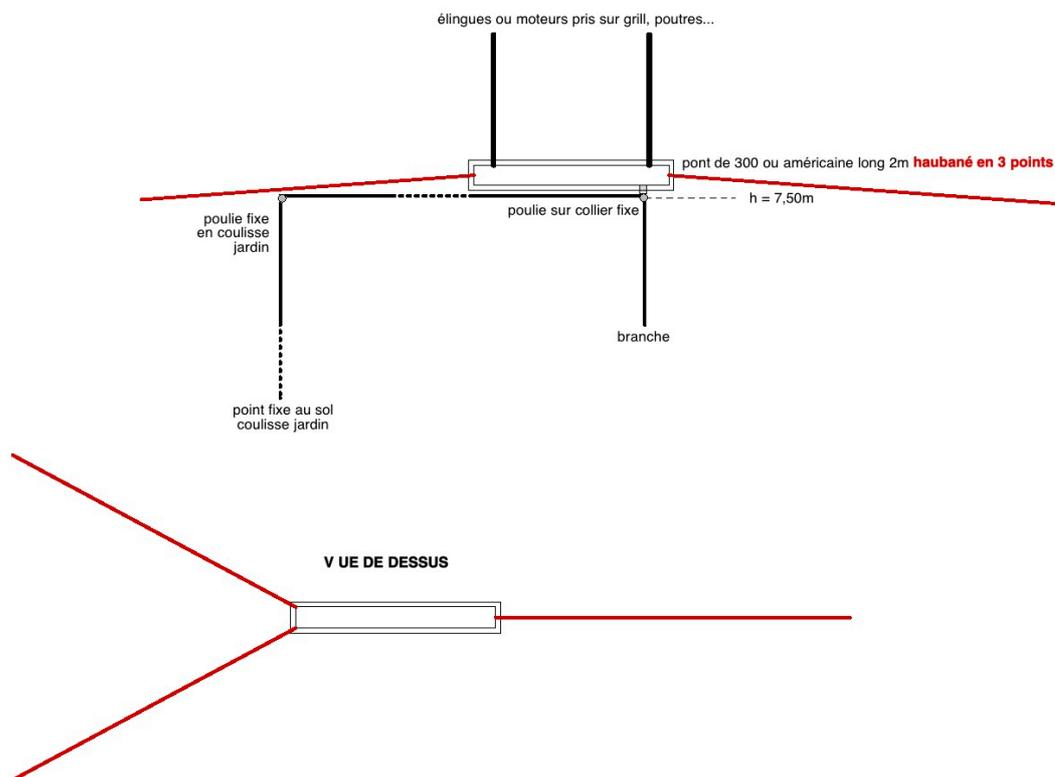
Sur ce point fixe, une poulie et une drisse  $\varnothing 5\text{mm}$  à âme kevlar, reprise en coulisse jardin à l'aplomb >> **point d'accroche adhoc au sol ou au mur à une hauteur accessible, ou chèvre peinte à 300kg.**
